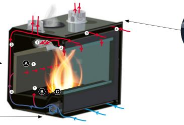
A · Vermiculite / Neotherm inside / B · Cast iron grate / C · Big ash draw
